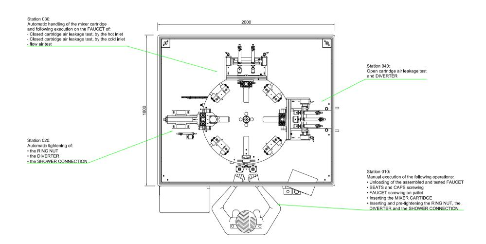
ASSEMBLY AND TESTING MACHINE FOR SHOWER AND BATH MIXERS
